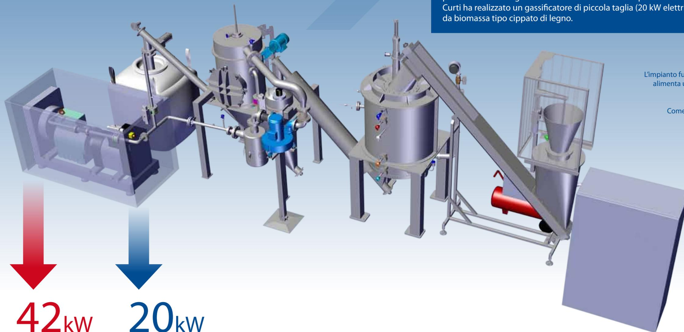
L'impianto funziona trasformando il cippato in un syn-gas con cui si alimenta un gruppo motore a combustione interna e alternatore e si produce energia elettrica.
